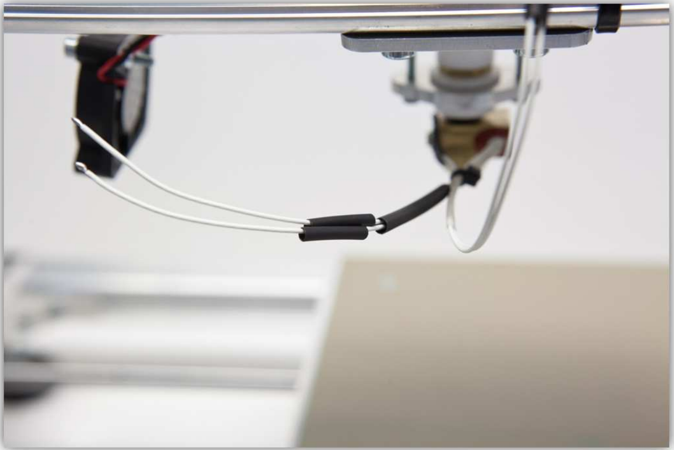
Vertin de draden van de NTC-thermistor.
