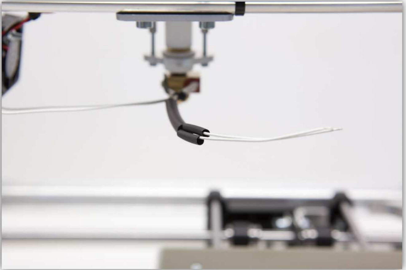
Vertin de kabels van het verwarmingselement.
